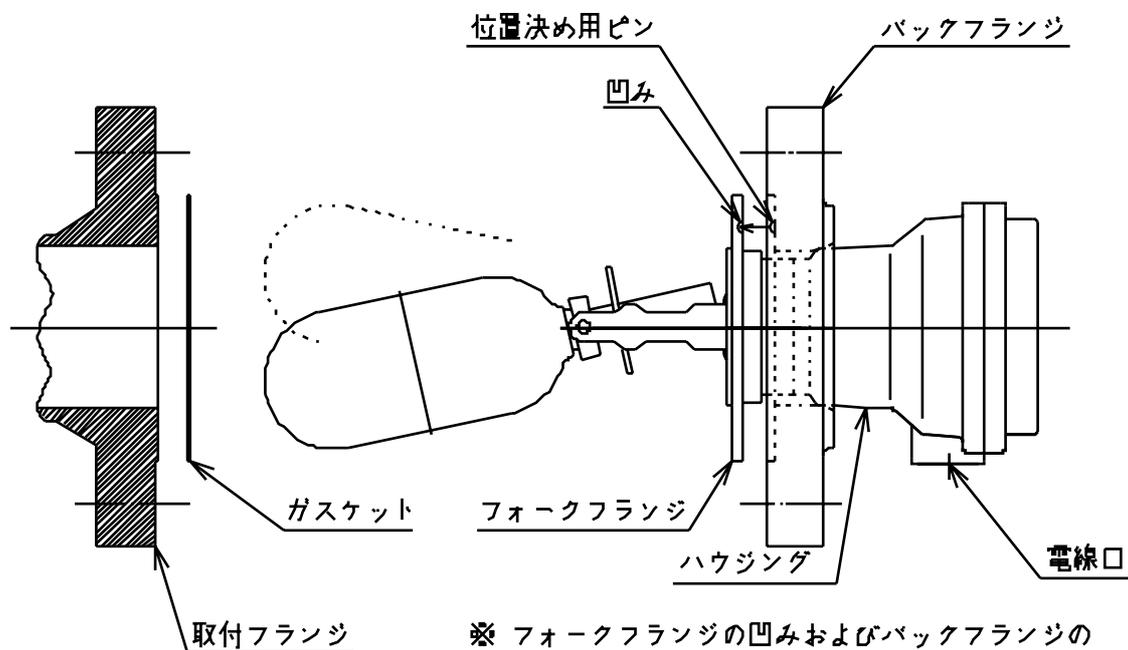
※ フォークフランジの凹みおよびバックフランジの位置決め用ピンが吻合するように据え付けること。
